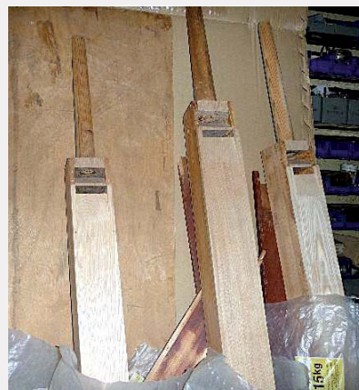
Tuyaux de soubasse en restauration : il y en a 50, de 20 cm à 250 cm
