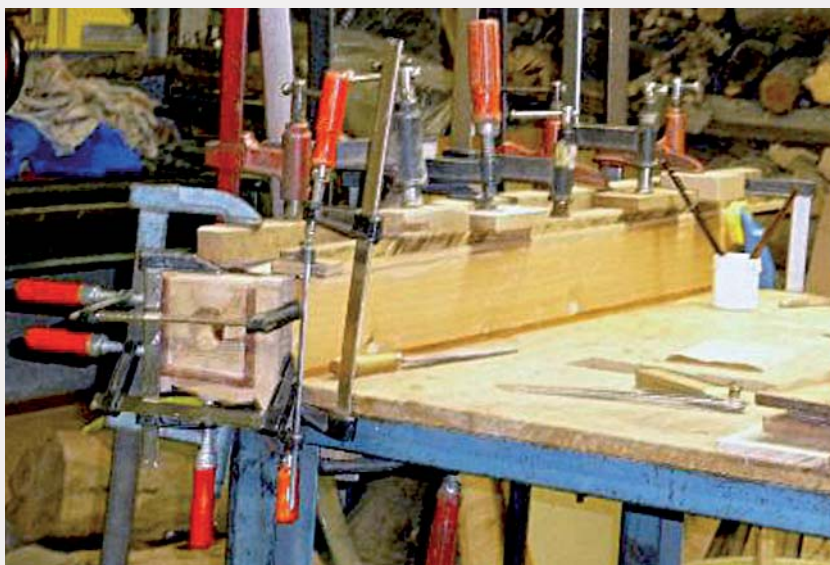
Tuyaux de soubasse en restauration : il y en a 50, de 20 cm à 250 cm
